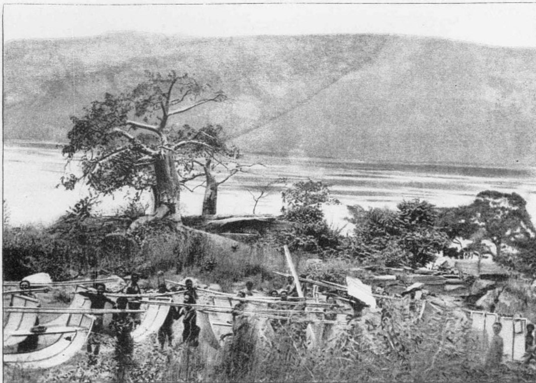
Les embarcations, dites baleinières ou allèges, se transportent en sections que l'on remonte à Léopoldville par boulonnage avec bandes de caoutchouc; deux hommes suffisent au transport d'une section; poids : 45 à 50 kilos.
